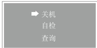
3. 在关机位置按下确认键，执行关机操作（并机状态未设置的状态下进行关机）
