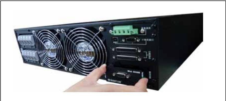
注：智能插槽支持热插拔，所以在安装以上卡的过程中不需要停止 UPS。
