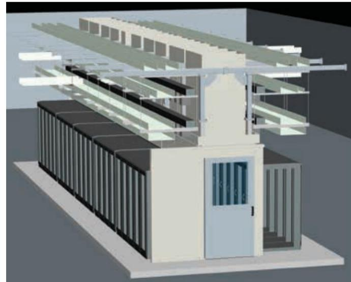
独立式气流抑制系统的机柜行末端安装门采用单门弹簧门，提供RPP操作板和垂直气流抑制墙体和上走线线缆盘支撑结构。
